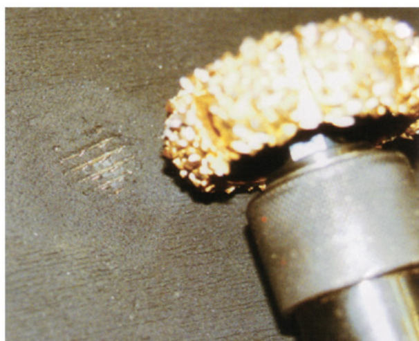
Abaixo, ferramenta de 1/2" x 2", carbide de 16 grânulos, excelente para remoção de borracha sem queimá-la.
