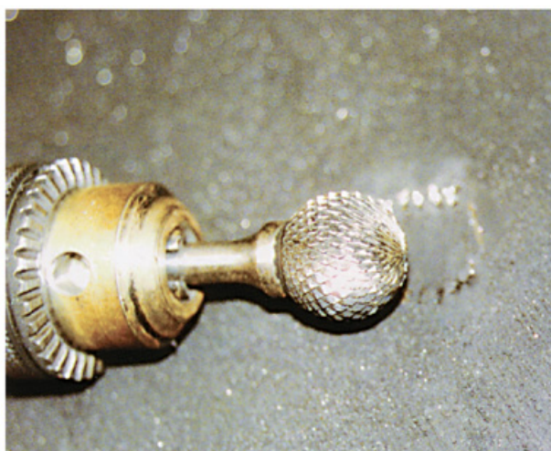
Ao lado, este, de carbide e aço, é muito efetivo para borracha e aço, cortando a extremidade dos cabos a 20.000 rpm.
