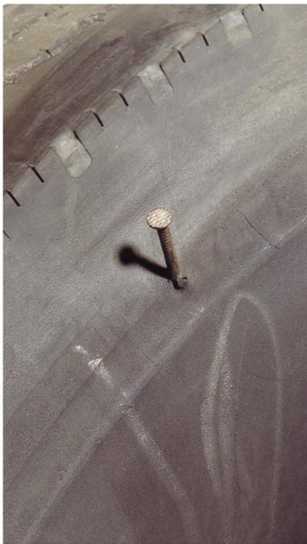
Penetração de um prego na lateral (costado) de um pneu.
